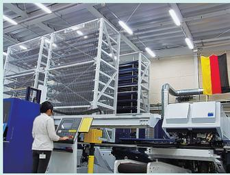
ドイツトルンプ社製の最新鋭レーザープレスマシン。ICTとの融合で、安定した製品を高品質で製造し、完全自動化による24時間稼働も可能。
